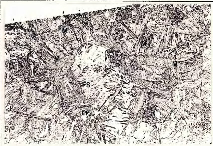
Fig. 8.9(b) Steel B HI=1.5kJ/mm Hv= 386-358 374.9 300X
