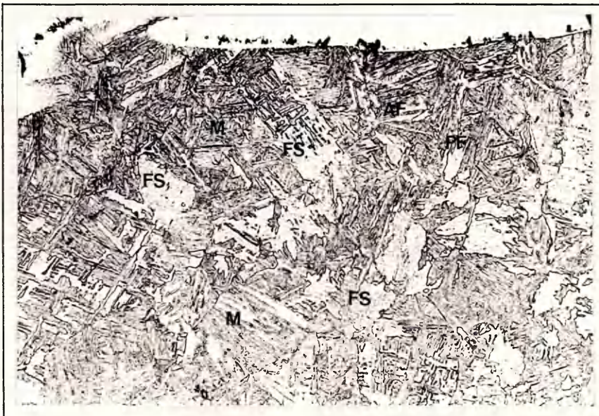
Fig. 8.9(d) Steel B HI=2.5kJ/mm Hv= 286-260 270.8 300X
