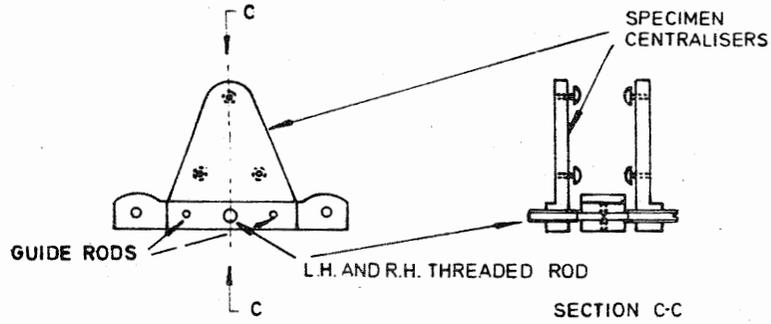
**b) SPECIMEN CENTRALISING DEVICE**
